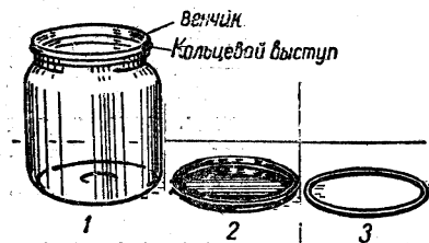
Рис. 9. Банка с крышкой и кольцом для герметизации.
